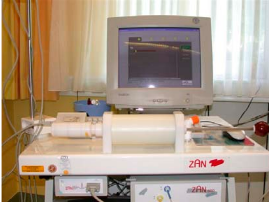
Abb.: 7 - Volumenkalibration und Aktualisierung der Umgebungsfaktoren am Untersuchungstag (BTPS-Standards)
